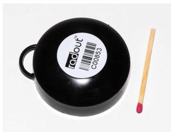
Abbildung: Radondosimeter radout™
